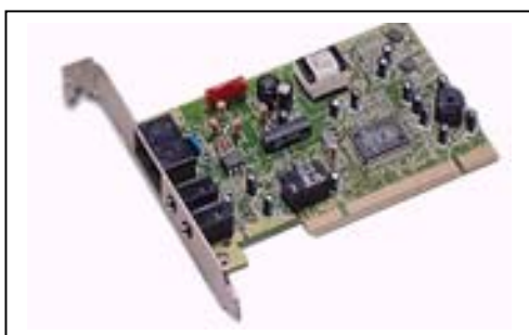
ภาพโมเด็มติดตั้งภายใน
